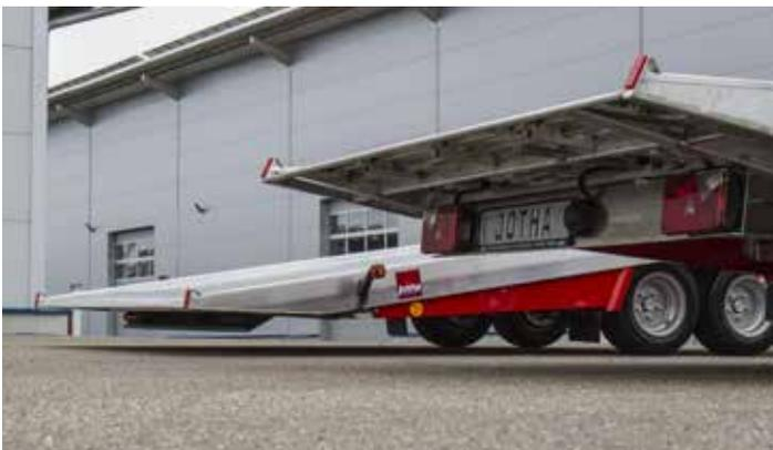
Beim Kippen klappt der Lichtkasten automatisch unter die Lade-
