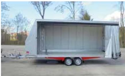
Extrem robuster Planen / Spriegel-Aufbau, rechts und links Schiebeplane mit Spannverschlüssen. Hinten gasfederunterstützte Klappe, vorne aero-dynamisch angeschrägt. Innenhöhe ca. 1.800 mm, Einfahrhöhe ca. 1.700 mm, Einfahrtsbreite 2.100 mm
