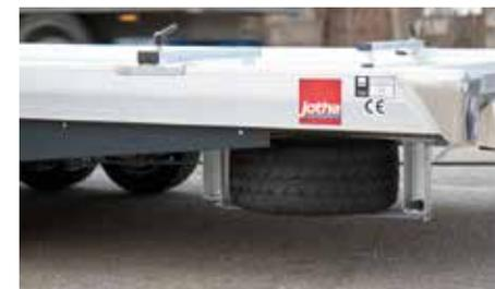
Der Halter für das Ersatzrad wird rechts vorne unter der Ladefläche montiert. Das Ersatzrad ist mit zwei Schrauben gesichert.
