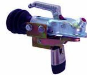
Diebstahlsicherung für Anhänger. Auch im Fahrbetrieb verwendbar. (nicht für Schlingerschutzkupplungen).
