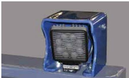
Schutzeinhausung des LED Arbeitscheinwerfers mit Alublech. Lackiert in der Farbe der Kotflugel.
