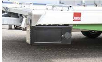
B: 220 mm × H: 215 mm x T 510 mm. Inhalt ca. 15 Liter. Die Staukiste eignet sich zum Verstauen der Zurrgurte und ist links vorne unter der Ladefläche montiert.
