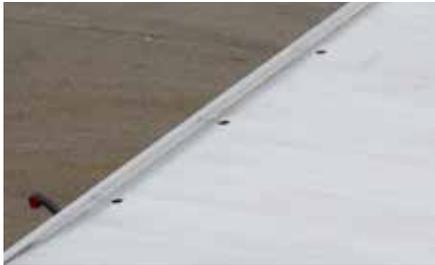
Zwei zusätzliche verstärkte Zurrpunkte rechts und links in der Plattform der Anhänger- und Aufbau-serien mit geschlossenem Boden mit einer Ladeflächenbreite von 2.100 mm.
