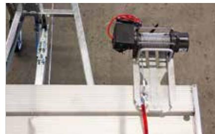
Zugkraft: 3.560 kg. Drei-stufiges Planetengetriebe mit mechanischer Kegelbremse. Kabelfernbedienung, 12 m Stahlseil. Ohne Verkabelung zum Zugfahrzeug. Stufenlos seitverstellbar und abnehmbar. Anstelle der Gurtbandwinde.
