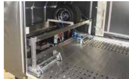
Reifenhalterung an der Bugwand des Planengestells, des Koffers oder am Bugrahmen des Anhängers.
