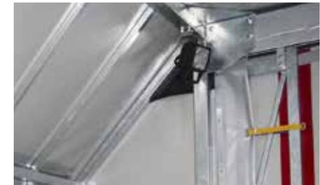
LED-Arbeitscheinwerfer (1.600 lm) mit Schalter an der Bugwand rechts- oder links oben montiert. Inklusive Anschluss an den Anhängerstecker.
