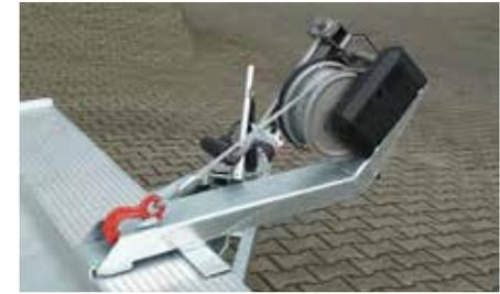
Stufenlos seitenverstellbare Handseilwinde auf Windenbock mit Freilauf zum Seilauszug. Stahlseil mit Lasthaken und einer Gesamtlänge von 10 m. Aufpreis zu der Handwinde mit Gurtband.
