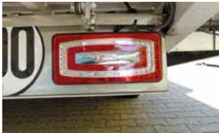
Lichtanlage komplett mit LED anstelle der Lichtanlage mit Glühbirnen. Für Zugfahrzeug mit LED-Lichtanlagenerkennung oder Einbau einer LED -ontrollbox (Bestell-Nr.: 50227).
