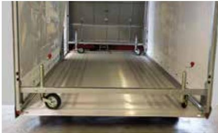
Vorrichtung zum Abnehmen des Planenaufbaus bestehend aus vier Hubwinden und Lenkrollen.
