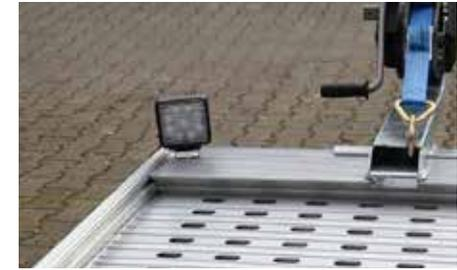
LED-Arbeitscheinwerfer (1.600 lm) an der Anhangerplattform links montiert (bei 2: r+l). Stromversorgung durch Dauerstrom uber den 13-poligen Stecker zum Zugfahrzeug, inklusive Schalter. (Seilwinde nicht mehr ganz seitlich verstellbar.)
