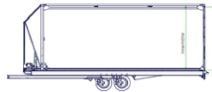
Verringern oder Erhöhen der Höhe des Aufbaus in Schritten von 100 mm im Bereich zwischen 1.600 mm und 2.600 mm.
