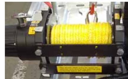
Zugkraft: 3.560 kg. Drei-stufiges Planetengetriebe mit mechanischer Kegelbremse. Kabelfernbedienung, 15 m Kunststoffseil. Ohne Verkabelung zum Zugfahrzeug. Stufenlos seitverstellbar und abnehmbar. Anstelle der Gurtbandwinde.
