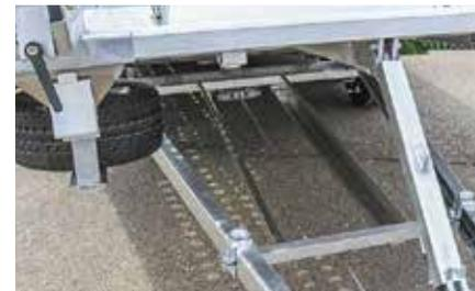
Zwischen die Zugdeichsel montierter Halter. Die FastLine Auffahrschienen sind sicher unter der La-defläche verstaut und durch die Plattform arretiert.
