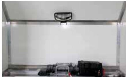
Idealer Überblick bei der Einfahrt in den Planenaufbau. Der Panoramaspiegel wird mittig an der Bugwand des Aufbaus montiert.
