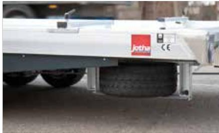
Der Halter für das Ersatzrad wird rechts vorne unter der Ladefläche montiert. Das Ersatzrad ist mit zwei Schrauben gesichert.
