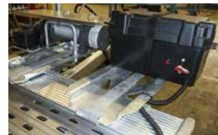
Batterie Optima blau 12 V / 55 AH in Kunststoff Staukiste auf eigenem Windenbock. Mit Ladekontrollleinrichtung und Relaissschaltung zum Trennen vom Zugfahrzeug im Betrieb. Angeschlossen an dem 13-poligen Anhängerstecker.
