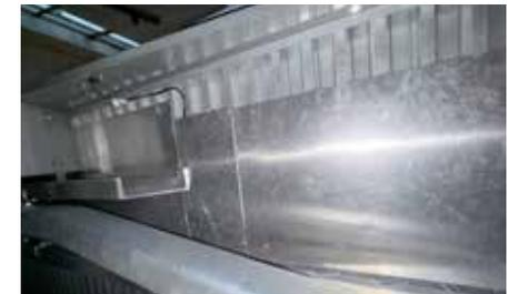
Bepankung der Unterseite des Lochblechplateaus mit Alu-Blechen als Spritzschutz. Empfohlen für Anhänger mit Planen- oder Kofferaufbauten.
