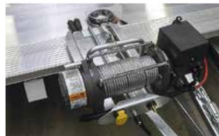
An der Seilwinde wird eine zweipolige Steckverbindung (Nato) montiert. Für die Montage am Zugfahrzeug liegt eine Nato-Steckdose separat bei. Inklusive 3 m loses Verbindungskabel. Die Verbindung muss während der Fahrt getrennt werden.
