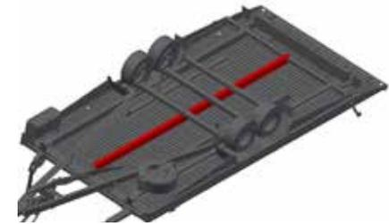
Zusätzlicher Unterzug in der Mittelspur der Plattform zum Transport schwerer Fahrzeuge mit schmäler Spurbreite.
